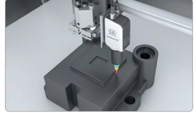
3D 프린팅에 통합되어 변위 및 거리 측정
