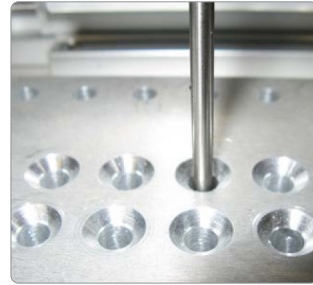
IFS2402/90 센서를 사용한 작은 타공의 직경 측정
