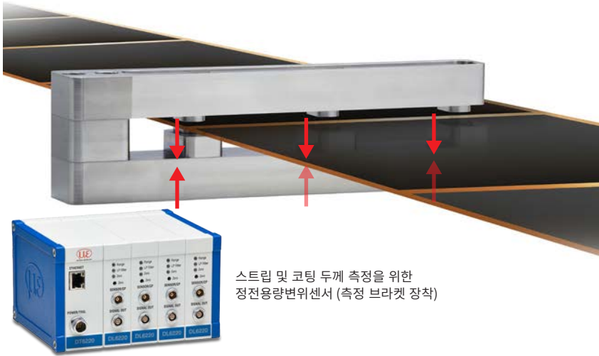
양면 두께 측정을 통해 정전용량변위센서는 스트립 두께를 높은 정확도로 감지합니다. 우수한 온도 안정성으로 인해 고온에서도 사용할 수 있습니다.
