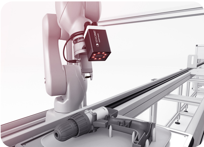
VISOR ® 로보틱을 이용해 센서 하우징의 위치를 정확하게 결정 할 수 있습니다. 오프셋 데이터는 로봇의 이동 경로를 수정하는데 사용됩니다.
