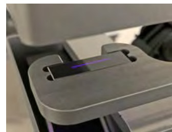
전자동 캘리브레이션으로 높은 측정 신뢰도 구현 (사진: thicknessGAUGE, laser profile)
