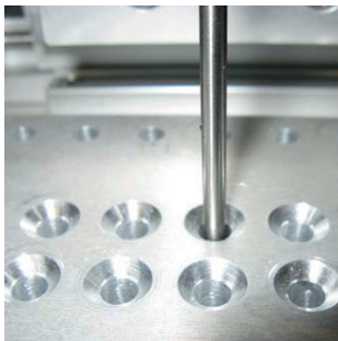
IFS2402 / 90센서를 사용한 작은 타공의 직경 측정
